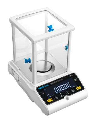
Luna分析天平拥有一系列的功能和特征,满足了大多数实验室应用。Luna系列提供了更高的性能,速度更快,读数更精确。凭借现代化的时尚设计,Luna令人印象深刻,彰显出一种智慧和成熟。LCD的大液晶显示屏,让黑色背景上的24mm高的白色字体清晰可辨。多语言文本和显示功能使Luna非常适合不同地区的用户。Luna提供了USB和RS-232两种接口,方便数据收集,及传输到电脑和打印机。ABS塑料外壳和坚固的304级不锈钢秤盘,使Luna在经受大意操作后便于清洁。精度为0.0001g的天平,Luna提供了四种型号,量程最高达250g,可以进行基本的、详细的测量任务。
